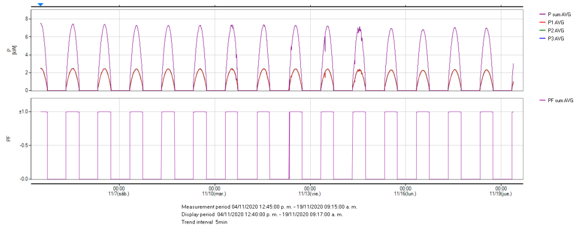
Gráfica de perfil de potencia en SFV de 10 kWp
